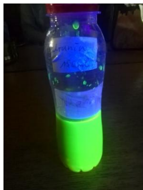
Bilder 7+8: Lösungen mit Uranin (links: unter normalen Licht ; rechts: unter UV-Licht: 366nm) (Lösungen: 3ml Uranin in 150ml Wasser gelöst)
