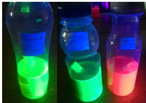
Bilder 13+14+15: Lösungen mit gelben, grünen bzw. roten Textmarker (links: unter normalen Licht ; rechts: unter UV-Licht: 366nm), (Lösungen: Textmarker in 150ml Wasser gelöst)
