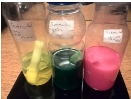
Bilder 13+14+15: Lösungen mit gelben, grünen bzw. roten Textmarker (links: unter normalen Licht ; rechts: unter UV-Licht: 366nm), (Lösungen: Textmarker in 150ml Wasser gelöst)
